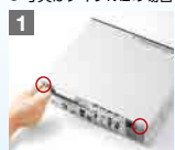
1 ネジを手で回して取り外し、 ロックを解除します。
