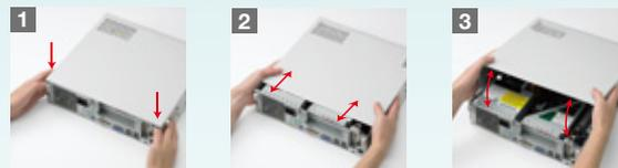
1 左右のスライドストップを下にずらして、ロックを解除します。
