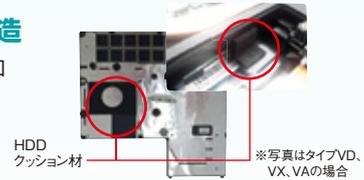
HDD クッション材    \*写真はタイプVD、
