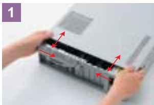
1 スライドストップを内側にはずらして ロックを解除し、 カバーを前後に水平に滑らせます。
