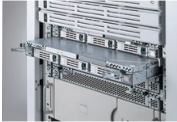
システム稼働中にモジュール単位で保守交換が可能です。写真はシステム稼働中にPCIモジュールを保守交換している320Lb-R。
