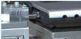
コネクタ挿抜試験の様子
