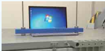
ランダム振動試験の様子
