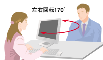
■筐体回転(左85°、右85°) (台座底面部分に回転台を装備)
