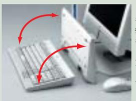
「テンキー付きPS/2小型キーボード」「テンキー付きUSB小型キーボード」は、キーボードを使用しない時に立てて収納できるスタンドタイプとなっており、机上の作業スペースを確保できます。
